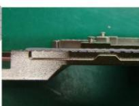
NC61/CNT25 FIP导电胶水，50的硬度可以实现50%压缩量，类比其他胶水可增加0.1mm高度，结合更紧密。在侧方有2-3dB优化
